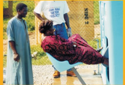
Una mujer de la comunidad pedalea para extraer agua demostrando el sistema secundario del SolarPedalflo™.
