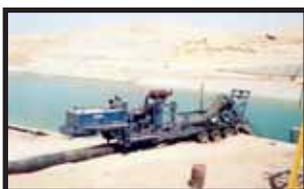
Esta HydraFlo™ Móvil de 30" se utiliza en el norte del Sinaí, Egipto para el alivio temporal mientras se construye una estación de bombeo permanente. La tubería conectada a la manguera de la descarga se utiliza para transportar agua sobre una milla a través de un sitio de construcción para propósitos de irrigación. Este modelo 3000M puede bombear hasta 35,000 galones de agua por minuto.
